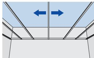
Una vez concluido el montaje de la estructura inferior, controlar toda la superficie del cielorraso para asegurarse de que los perfiles portantes estén bien orientados. Ajustar los colgadores de sujeción rápida de modo que estén firmes y la estructura quede nivelada.
