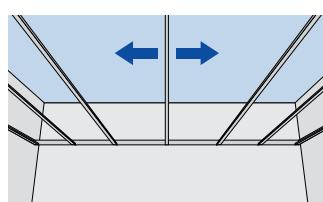
Une fois le montage de la sous-construction achevé, contrôler l'ensemble de la surface du plafond de manière à orienter les profilés porteurs correctement. Régler les suspensions rapides pour obtenir un maintien ferme et une structure plane.
