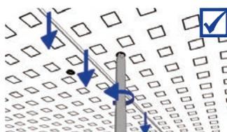
Imprimación de la superficie del cielorraso con Vogl Supergrund LF, el sustrato debe estar seco, libre de suciedades y de sustancias separadoras. Aplicar la imprimación sin diluir mediante el rodillo de piel de cordero. Tiempo de secado: 12 h
