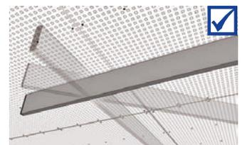
Colocar la capa amortiguante para el reverso directamente encima de los paneles de cielorraso.
