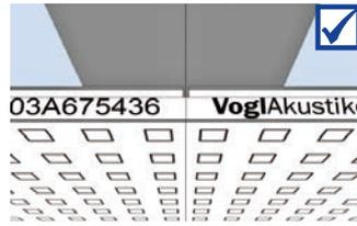
Utilizar el perfil CD o regla/cartabón como tope, para el posicionamiento empujar el siguiente panel junto al perfil CD/ regla/cartabón hacia el primer panel y fijarlo.
