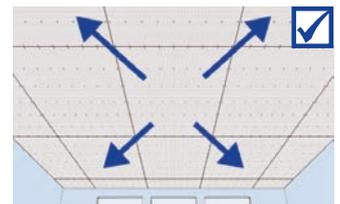
Los demás paneles de cielorraso se colocan junta contra junta, siempre se debe comprobar que las zonas de junta estén a nivel y, a continuación, se elaboran en el sistema «juntas en cruz».
