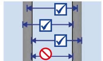
Al mirar desde el área de acceso, se deberá escoger una disposición de paneles con el borde transversal paralelo a la ventana (dirección principal de la luz).
