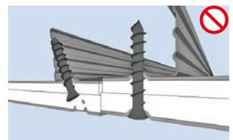
Distancia máxima entre tornillos 170 mm de punto de fijación a punto de fijación. Distancia máxima entre tornillo y borde exterior del panel 26 mm. Se deberá evitar causarle daños al panel de diseño acústico con las cabezas avellanadas de los tornillos.
