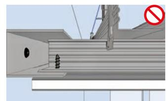
Cada 10 m/100 m<sup>2</sup> se deberá prever una junta de dilatación de 5 - 10 mm.
