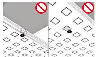
Primeramente se atornilla el panel de cielorraso en el medio del mismo con la estructura sustentante, se desciende el elevador de paneles, después se coloca un tornillo en el medio del borde de cada lado transversal, a continuación se atornillan los lados longitudinales.
