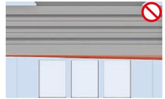
A continuación se deben controlar las distancias entre ejes de perfiles de cielorraso CD y, si es necesario, reajustarlas. Los conectores longitudinales siempre se deben aplicar desfasados (véase la ilustración). Medir correctamente las distancias entre ejes.
