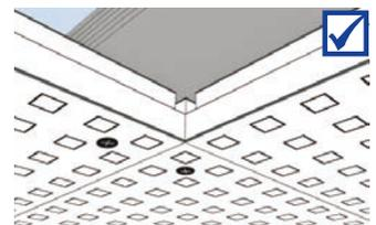
Una vez concluido el montaje de los paneles se debe volver a controlar que todas las zonas de juntas estén a nivel, si es necesario se reajustan con destornillador y, a continuación, se comprueban con regla/cartabón.
