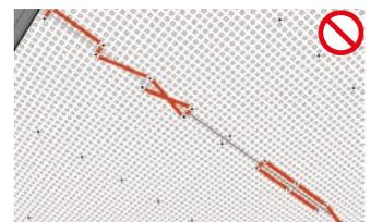
Primeramente se colocan los paneles de cielorraso en dirección de los lados longitudinales, después en dirección de los lados transversales, de modo que se logra un cruce exacto en el cielorraso, a continuación se montan las zonas restantes desde el medio del local hacia afuera con el mismo modo de proceder.
