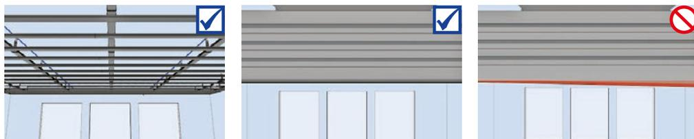
A continuación se deben controlar las distancias entre ejes de perfiles de cielorraso CD y, si es necesario, reajustarlas. Los conectores longitudinales siempre se deben aplicar desfasados (véase la ilustración). Medir correctamente las distancias entre ejes.
