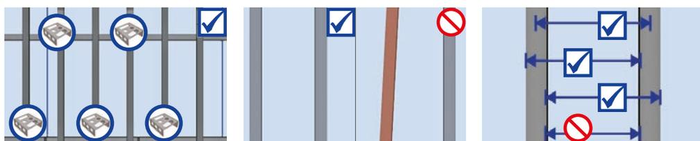
Al mirar desde el área de acceso, se deberá escoger una disposición de paneles con el borde transversal paralelo a la ventana (dirección principal de la luz).
