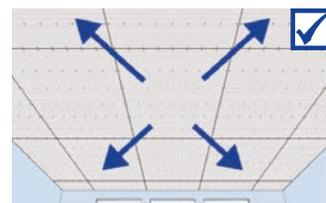
Los demás paneles de cielorraso se colocan junta contra junta, siempre se debe comprobar que las zonas de junta estén a nivel y, a continuación, se elaboran en el sistema «juntas en cruz».
