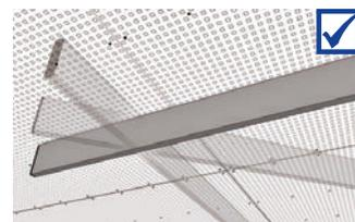
Colocar la capa amortiguante para el reverso directamente encima de los paneles de cielorraso.
