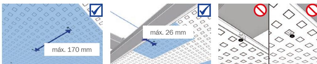
Primeramente se atornilla el panel de cielorraso en el medio del mismo con la estructura sustentante, se desciende el elevador de paneles, después se coloca un tornillo en el medio del borde de cada lado transversal, a continuación se atornillan los lados longitudinales.
