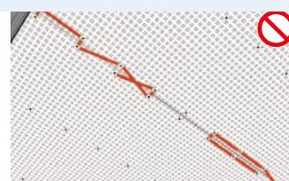
Primeramente se colocan los paneles de cielorraso en dirección de los lados longitudinales, después en dirección de los lados transversales, de modo que se logra un cruce exacto en el cielorraso, a continuación se montan las zonas restantes desde el medio del local hacia afuera con el mismo modo de proceder.
