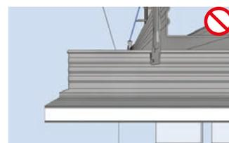
Cada 10 m/100 m<sup>2</sup> se deberá prever una junta de dilatación de 5 - 10 mm.
