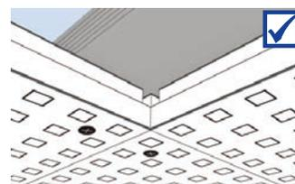
Una vez concluido el montaje de los paneles se debe volver a controlar que todas las zonas de juntas estén a nivel, si es necesario se reajustan con destornillador y, a continuación, se comprueban con regla/cartabón.
