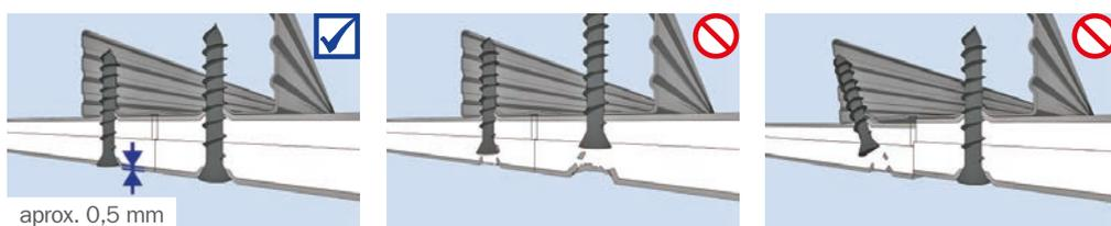
Distancia máxima entre tornillos 170 mm de punto de fijación a punto de fijación. Distancia máxima entre tornillo y borde exterior del panel 26 mm. Se deberá evitar causarle daños al panel de diseño acústico con las cabezas avellanadas de los tornillos.
